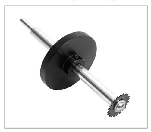
Резаки для отрезания труб изнутри (дренажные трубы, трубы разбрызгивателей и др.) с пилообразными лезвиями из термически обработанной стали для быстрого отрезания трубы (модели IC1S, IC1SL и IC3/4L), или с абразивными лезвиями для тех участков, где лезвие может касаться бетона или других твердых поверхностей (модели IC1A и IC1AL).
