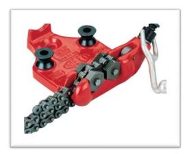
Цепные тиски незаменимы, если надо закрепить предмет с нестандартной поверхностью. Цепь накидывается на поверхность любой формы и затем всего двумя оборотами рукоятки легко закрепляется или ослабляется - быстрота работы является одним из достоинств данного типа тисков. Трехсторонние губки, используемые в этих тисках, значительно увеличивают срок службы без замены комплектующих.
