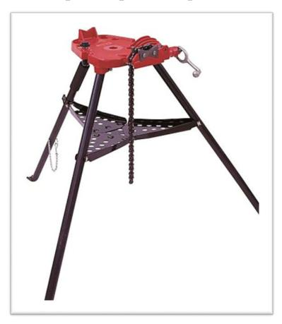
Верстаки Reed отличаются повышенной прочностью и долговечностью благодаря ряду конструктивных особенностей - усиленным заклепкам, зажимам, перекрывающимся петлям и т.д., что позволяет работать на них длительное время без потери прочности. Максимальный диаметр труб, с которыми позволяют работать эти верстаки-треноги - 6" (152 мм). Они подходят как для металлических, так и для пластиковых труб благодаря двухсторонним щекам тисков.
