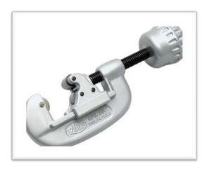
Удобные и популярные труборезы по меди. В крутящуюся рукоятку вмонтирована зенковка для удобства использования инструмента. Широкие прижимные ролики надежно фиксируют трубу, а тонкий ролик обеспечивает быстрый и ровный отрез.
