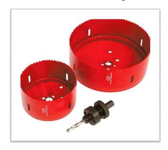
Корончатые сверла с разным наклоном зубьев для алюминия, чугуна, PVC, мягкой, инструментальной и нержавеющей стали, а также дерева. Глубина пропила – 1 7/8 (60 мм) для канализационных вентилей. МЗ - ударопрочные высокоскоростные резцы с долгим сроком службы, они гораздо прочнее резцов М2. У резцов переменная конструкция, что обеспечивает мягкость сверления и гасит вибрацию. Специальное резьбонарезное масло рекомендуется применять при работе со сталью. Чугун и ПВХ сверлятся с использованием воды.
