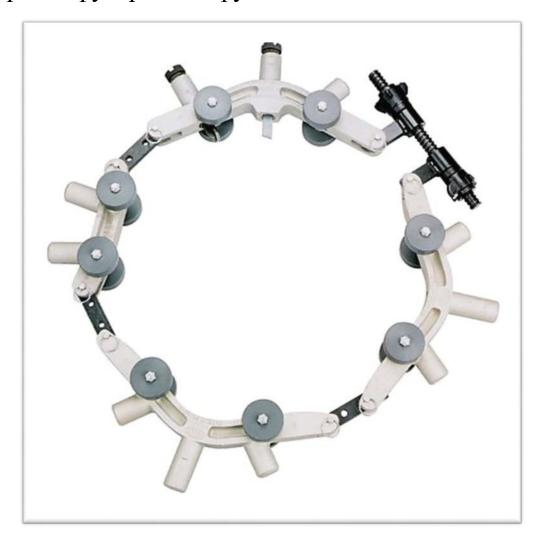
Труборезы для работы как на земле, так и в траншее. Благодаря своей конструкции они требуют совсем небольшое свободное пространство вокруг трубы - 150-200 мм. Ролики выравнивают резак, обеспечивая точность реза. Возможен одновременный скос 15° с обеих сторон реза. На лезвиях установлены прочные победитовые напайки, которые позволяют работать с трубами с толщиной стенки до 2" (50 мм). В комплекте поставляются лезвия как для прямого, так и для скошенного отреза.
