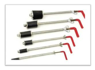
Набор для остановки конденсата, мешающего быстрой пайке. Инструмент вводится в трубу, а затем закручивается гайка-барашек, при этом уплотнитель расширяется и останавливает воду. Не поворачивается вокруг оси, всегда сохраняет L-образный профиль. Также может использоваться для снятия неисправных вентилей. Помимо отдельных инструментов для разных диаметров труб, также имеется два набора для диапазона диаметров 12,5 - 63 мм.
