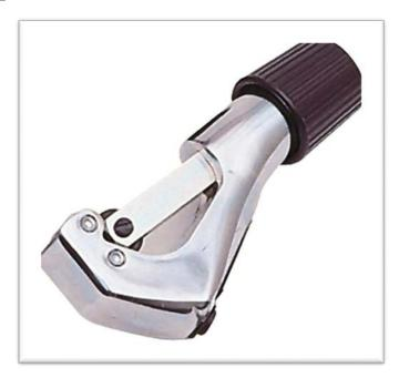
Телескопические труборезы с корпусом из алюминиевого сплава, хромированные и никелированные. Принцип действия: встроенный подающий винт с удобной рукояткой прижимает сменный режущий ролик к трубе, а прижимные ролики удерживают ее в нужном положении. С помощью зенковки обрабатывают кромку отреза отрубы.
