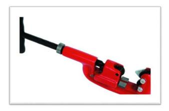
RG1.5 - устройство для накатки желобков на трубах диаметром до 1 1/2" (51 мм) с толщиной стенки до 4,5 мм. Устройство RG1.5KIT преобразует труборез 2" в желобонакатчик путем снятия режущих роликов и установки вальцовочных кругов для накатки желобков, выравнивающей пластины и фланца регулировки глубины. Набор RG1.5GRWH включает в себя круги для накатки желобков. Для работы с трубами диаметром более 2" следует пользоваться инструментами RG6, RG6HdCOMBO или RG26.
