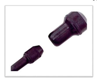
Инструменты из высококачественной стали для развальцовки и создания раструбов в 45° на трубах из мягкой меди типа К, имеют направляющие большего размера, а также места для захватывающих штифтов, что обеспечивает безопасность при работе. Используется вместе с латунным молотком с мягкой поверхностью длиной 368 мм, сделанным специально для работы с вальцовочными инструментами.
