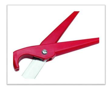
Ножницы для быстрого отрезания тонкостенных труб небольших диаметров из полиэтилена, резины, нейлона. Для облегчения работы ножницы при отрезании необходимо проворачивать вокруг трубы. Модели CS1 и SC125 оснащены сменными лезвиями, покрытыми тефлоном. Более прочные лезвия из нержавеющей стали (Sc1BSS) лучше подходят для отрезания труб из PVC. В наличии имеются запасные лезвия.
