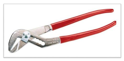
Литая конструкция со шлицами позволяет работать одной рукой, зубцы на губках нарезаны по типу трубных ключей, носовая часть расположена под углом 32°. Во избежание коррозии все металлические части оцинкованы. Клещи могут работать с довольно большими размерами гаек до 38 мм, максимальный захват - 51 мм. Что особенно удобно в работе - рукоятки всегда остаются параллельны друг другу вне зависимости от раскрытия губок.
