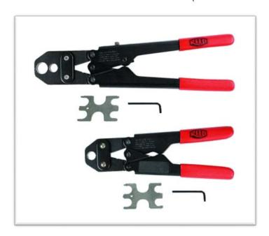
Клещи для обжима медных колец на латунных фитингах систем PEX, благодаря своей конструкции не оставляют на кольцах засечек и не деформируют их. Системы PEX используются для водопроводов питьевой воды, радиального отопления, а также для снегоплавильных сетей. В комплекте поставки каждого инструмента есть шестиугольный ключ и прибор для проверки годности клещей.
