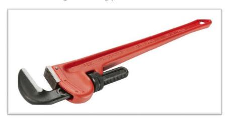
Наиболее распространенные ключи при работе с трубами. Прочная ковкая рукоятка и укрепленные легированной сталью части делают этот ключ пригодным к использованию в самых тяжелых условиях. Коленчатые ключи - аналогичны по конструкции, но иногда более удобны при работе в труднодоступных местах за счет наклона. Труба захватывается верхней щекой и упирается на нижнюю, жестко фиксируясь между ними.
