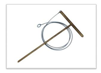
На пластиковых трубах в процессе эксплуатации неизбежно скапливается статическое электричество, что может привести к образованию искры и воспламенению при соответствующей смеси воздуха и газа. Устройство для заземления статического электричества рассеивает статический заряд в трубах во избежание воспламенения или повреждений. Рекомендуется использовать это устройство при работе с гильотинами и обжимными инструментами.
