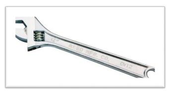
Ключи разводные с прочными рукоятками из кованой стали и параллельными губками, плотно обхватывающими гайку. Бронзовые фосфатированные пружины, снаружи - тройное никелехромовое покрытие. Ключи изготовлены из лучших материалов на рынке. Ползуны губок точно выверены, благодаря чему люфт сведен к минимуму. Очень удобны при работе в ограниченном пространстве.
