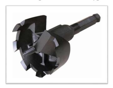
Самозаворачивающиеся буры были созданы специально в помощь электрикам и прокладчикам водопроводных путей для легкого бурения в дереве отверстий под трубы. Хвостовики буров - 1/2" с тремя фасками. Буры легко извлекаются из дерева и не застревают благодаря своей конической форме. Зубцы бура легко затачиваются с помощью напильника. Длина бура – 6 1/4" - (159 мм).
