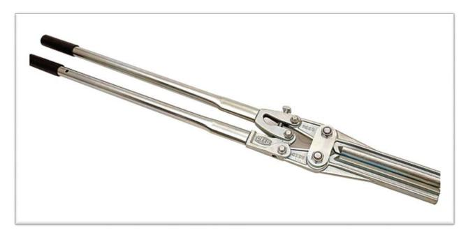
Инструмент для запирания в случае аварии пластиковых труб диаметром от 3/4" (19 мм) до 1" (25 мм). Длинные рукоятки 762 мм (30") позволяют работать по принципу болтореза и создавать достаточное усилие для перекрытия воды. Для хранения инструмента в сложенном состоянии предусмотрена защелка.
