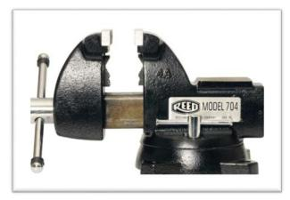
Эти тиски объединяют в себе две модели тисков - многоцелевые и слесарные. Сквозная балка соединяется с корпусом по прямой линии. Винт и гайка механизма тисков находятся внутри корпуса, благодаря чему удается избежать загрязнения механизма, и, следовательно, его износа. В комплекте с тисками поставляются щеки и сменные стальные губки. На поворотном основании - два фиксатора.
