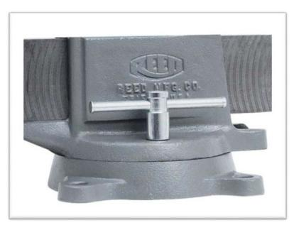
С помощью этого устройства любые стационарные тиски Reed можно преобразовать в поворачивающиеся. В комплект поставки входит пластина основания, стопорная гайка, боковой штифт и центральный болт.
