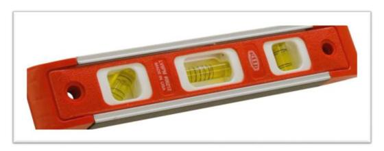
Алюминиевая рамка, магнитное основание, высокоточные кромки, ампулы с жидкостью отсчитывают шаг в 1/8", 1/4" или 3/8" на фут без регулировки, также есть ампулы для отвеса и скоса в  $45^{\circ}$ .
