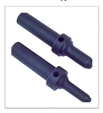
Вальцовки для работы с трубами при наличии воды в системе, что возможно благодаря отводящим каналам от конца вальцовки к бортику. Рекомендуется к использованию с трубами из мягкой меди типа К, а также с латунным молотком.
