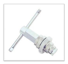
Ключ специально для снятия компонентов фитингов с трубопроводов, отвинчивания ниппелей, сломанных частей труб, сломанных вентилей ответвления от водопроводных систем и фитингов. Ключ IW341 очень удобен при работе с частями труб наиболее распространенных диаметров - 3/4 и 1 дюйм.
