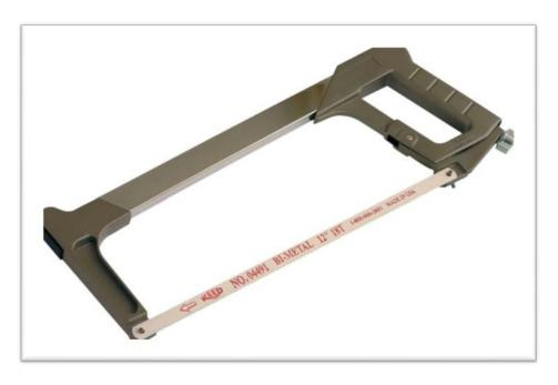
Пилы с прочными алюминиевыми и стальными рамами, которые обеспечивают напряжение на полотне 15,000 рsi (28,000 для модели НК1228), что позволяет производить более точные отрезы и увеличивает срок службы полотен. У биметаллических полотен высокоскоростная режущая кромка приварена электронной сваркой к основанию из легированной стали. Как рамы, так и полотна взаимозаменяемы с аналогичными деталями от компаний Stanley, Lenox, Starrett, M.K.Morse и RIDGID.
