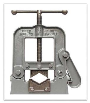
Данный модельный ряд тисков предназначен для операций, связанных с высокой нагрузкой и большим крутящим моментом, таких как отрезание труб, нарезание резьбы и т.п. Корпус тисков изготовлен из ковкого металла, а щеки из высокоуглеродистой прочной стали, что обеспечивает тискам надежность и долговечность. Тиски могут быть приспособлены как для право-, так и для левосторонних операций.
