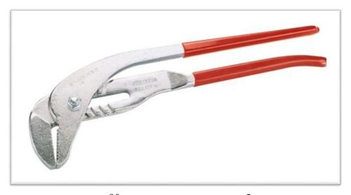
Губки, расположенные под углом 90 градусов, позволяют работать в труднодоступных местах. Рукоятки длиннее на 20%, следовательно, длиннее рычаг и меньше требуемое усилие. Конструкция язычковая, с канавками из легированной стали, закаленная для усиления прочности и оцинкованная с целью предотвращения коррозии. На рукоятке встроенный стопор, предохраняющий руки оператора от зажима.
