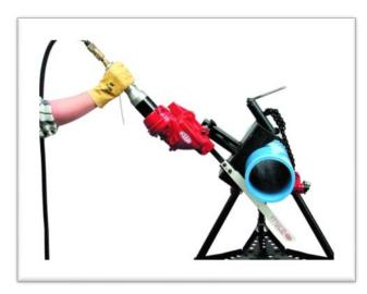
Пневматическая пила с возвратно-поступательным движением лезвий, подходит для труб из пластмассы, стали (в том числе нержавеющей), чугуна и ковкого чугуна. В стандартной комплектации работает с трубами диаметром до 305 мм, при приобретении цепных удлинителей способна резать трубы до 610 мм. Эту пилу удобно использовать с тисками Saw It, подходящими к трубам диаметром 4-12" (100-305 мм) и надежно фиксирующими пилу относительно трубы, обеспечивая точный и ровный отрез.
