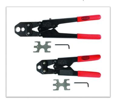
Клещи для обжима медных колец на латунных фитингах систем PEX, благодаря своей конструкции не оставляют на кольцах засечек и не деформируют их. Системы PEX используются для водопроводов питьевой воды, радиального отопления, а также для снегоплавильных сетей. В комплекте поставки каждого инструмента есть шестиугольный ключ и прибор для проверки годности клещей.
