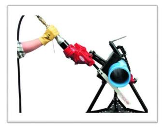
Пневматическая пила с возвратно-поступательным движением лезвий, подходит для труб из пластмассы, стали (в том числе нержавеющей), чугуна и ковкого чугуна. В стандартной комплектации работает с трубами диаметром до 305 мм, при приобретении цепных удлинителей способна резать трубы до 610 мм. Эту пилу удобно использовать с тисками Saw It, подходящими к трубам диаметром 4-12" (100-305 мм) и надежно фиксирующими пилу относительно трубы, обеспечивая точный и ровный отрез.
