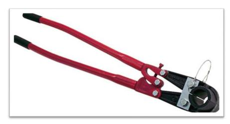
Инструмент осуществляет плотный захват труб диаметром от 3/4" до 2" (в зависимости от модели), применяется для удобства при разматывании бухты, при изгибе и закруглении труб для точного соединения фитингов, для крепкого и безопасного захвата при развальцовке перед сваркой и т.п. Инструменты CSR3/4 на 3/4 дюйма и CSR1 на 1 дюйм особенно удобны при работе с влажными водопроводными системами или в условиях ограниченного пространства.
