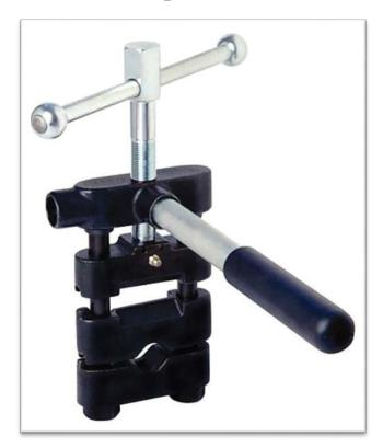
Инструмент легко проворачивается вокруг трубы и запирает ее или изменяет форму. Для труб диаметром от 3/4" до 2" (19-63 мм). Для увеличения срока службы все части защищены от коррозии. На запорных инструментах установлены пресс-масленки, что облегчает его использование.
