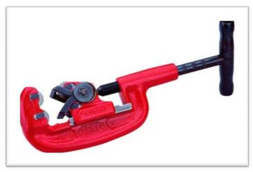
Труболрез с высокой точностью реза для стали и нержавеющей стали. Точность достигается за счет подпружиненных направляющих, а также тонких прочных роликов из инструментальной высококачественной стали.
