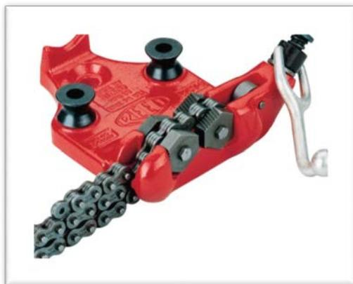
Цепные тиски незаменимы, если надо закрепить предмет с нестандартной поверхностью. Цеп накидывается на поверхность любой формы и затем всего двумя оборотами рукоятки легко закрепляется или ослабляется - быстрота работы является одним из достоинств данного типа тисков. Трехсторонние губки, используемые в этих тисках, значительно увеличивают срок службы без замены комплектующих.
