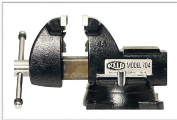
Эти тиски объединяют в себе две модели тисков - многоцелевые и слесарные. Сквозная балка соединяется с корпусом по прямой линии. Винт и гайка механизма тисков находятся внутри корпуса, благодаря чему удастся избежать загрязнения механизма, и, следовательно, его износа. В комплекте с тисками поставляются щеки и сменные стальные губки. На поворотном основании - два фиксатора.
