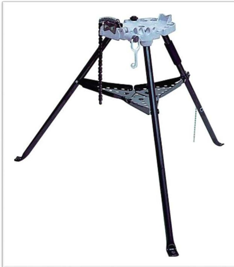
Тренога R450С для работы в стерильных помещениях поставляется с откидными зажимными губками из нержавеющей стали марки 410 (с резиновой накладкой с одной стороны), анодированным алюминиевым основанием и со скользящим патрубком из полимера, который легко снимается, для защиты цепи. Смазка для цепи используется пищевая (не на нефтяной основе).
