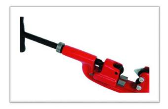
RG1.5 - устройство для накатки желобков на трубах диаметром до 1 1/2" (51 мм) с толщиной стенки до 4,5 мм. Устройство RG1.5KIT преобразует труборез 2" в желобонакатчик путем снятия режущих роликов и установки вальцовочных кругов для накатки желобков, выравнивающей пластины и фланца регулировки глубины. Набор RG1.5GRWH включает в себя круги для накатки желобков. Для работы с трубами диаметром более 2" следует пользоваться инструментами RG6, RG6HdCOMBO или RG26.
