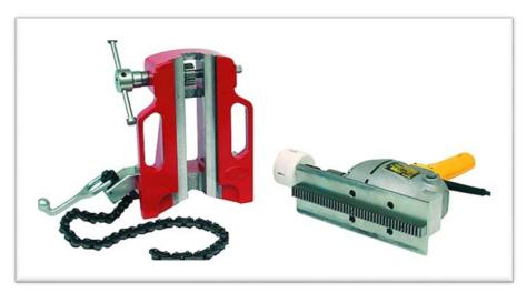
Станок состоит из станины с цепными тисками для крепления на трубе, и сверлильного механизма с регулятором заглубления. В комплект поставки входит станина, цепь со струбциной, держатель сверла с пластиной регулировки глубины сверления, а также чашечное свело. Станок применяется для работы с трубами от 1 1/4 до 10 дюймов (42- 273 мм). Диапазон допускаемых к использованию сверл - до 43/4 дюйма (120 мм). Работа допускается только с трубопроводами без давления. Сверла или резцы продаются отдельно.
