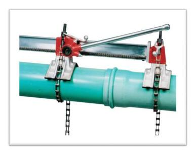
Устройство для соединения одним человеком ПВХ или ПЭ труб диаметром до 16" (405 мм) соединенных с помощью уплотнителя или до 12" (305 мм) соединенных с помощь растворимого цемента.
