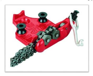
Цепные тиски стандартные TriStand могут удерживать как металлические трубы, так и пластиковые, за счет губок с резиновым покрытием, которые обеспечивают защиту поверхности труб из мягких металлов и пластика. Губки для металла и пластика легко переворачиваются для смены одних на другие.
