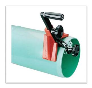
Прочный фаскосниматель из алюминиевого сплава с долгим сроком службы, имеет эффективную роликовую блокировку. Работает со всеми вимдами пластиковых труб, включая уплотненные трубы из полиэтилена и поливинилхлорида. Ровный отрез фаски 15° можно сделать за одну минуту. Длина скоса может составлять до 1 1/2" вне зависимости от толщины трубы. Регулировка под разные размеры и толщины осуществляется очень легко и не требует смены компонентов.
