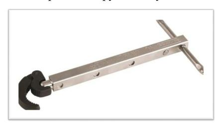
Ключ сделан специально для работы с бытовыми и промышленными раковинами для воды, в местах с затрудненным доступом, в резервуарах. Губки выполнены из цельнокованой стали и укреплены пружиной, что в совокупности с храповым механизмом позволяет работать одной рукой. Рукоятка у этих ключей телескопическая и может раскладываться на длину от от 10 до 17 дюймов (от 254 мм до 432 мм).
