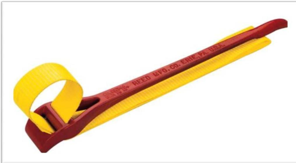
Ремешковые ключи используются при работе с трубами с покрытием из мягкого металла или пластика, обеспечивая бережный прочный захват. Также они используются при работе с деталями неправильной формы или со скользкими поверхностями. Ремни покрыты полиэстером, что исключает проскальзывание и обеспечивает долгий срок службы.
