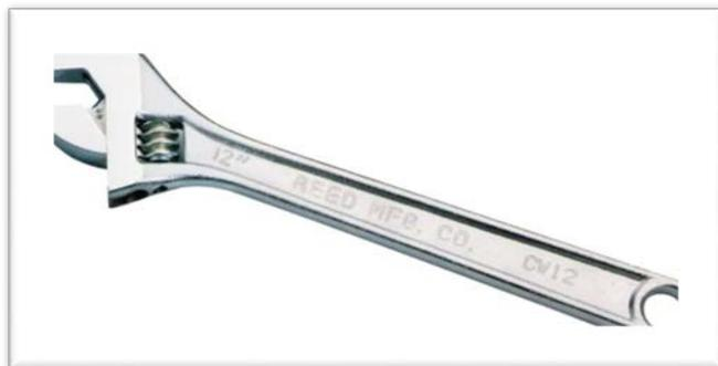
Ключи разводные с прочными рукоятками из кованой стали и параллельными губками, плотно обхватывающими гайку. Бронзовые фосфатированные пружины, снаружи - тройное никеле-хромовое покрытие. Ключи изготовлены из лучших материалов на рынке. Ползуны губок точно выверены, благодаря чему люфт сведен к минимуму. Очень удобны при работе в ограниченном пространстве.
