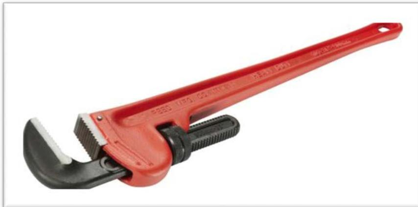
Наиболее распространенные ключи при работе с трубами. Прочная ковкая рукоятка и укрепленные легированной сталью части делают этот ключ пригодным к использованию в самых тяжелых условиях. Коленчатые ключи - аналогичны по конструкции, но иногда более удобны при работе в труднодоступных местах за счет наклона. Труба захватывается верхней щекой и упирается на нижнюю, жестко фиксируясь между ними.
